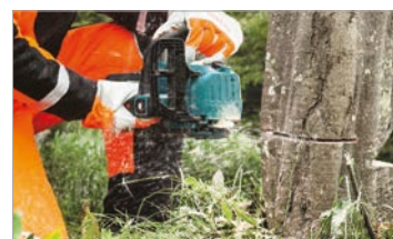
Taglio sicuro grazie al rampone in acciaio
