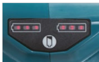
LED indicatori residuo carica batterie
