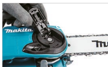
Manopola regolazione tensione catena senza utensili. Può essere ripiegata riducendo gli ingombri esterni
