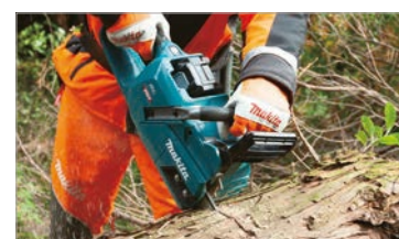
Taglio sicuro grazie al rampone in acciaio
